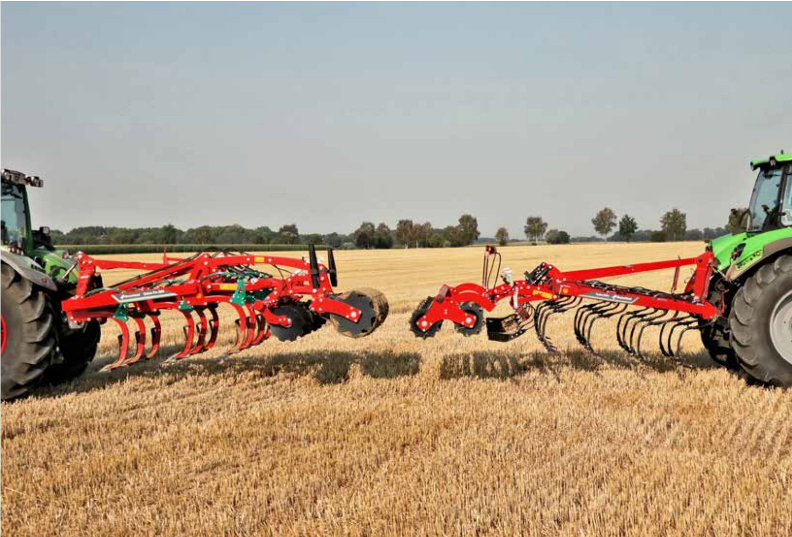
Links der dreibalkige Enduro Pro mit Triflexzinken und rechts der Turbo mit vier Reihen und Reflexzinken.
